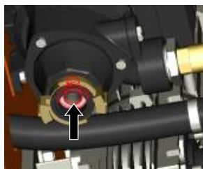
Ábra 46: Szennyfogó szita a vízbemenetben
