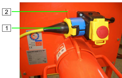
Ábra 38: A csatlakozókábel eltávolítása
