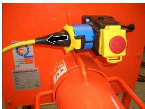
Ábra 45: A csatlakozókábel eltávolítása
