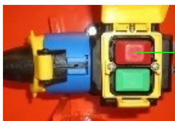
Ábra 34: A gép kikapcsolása
