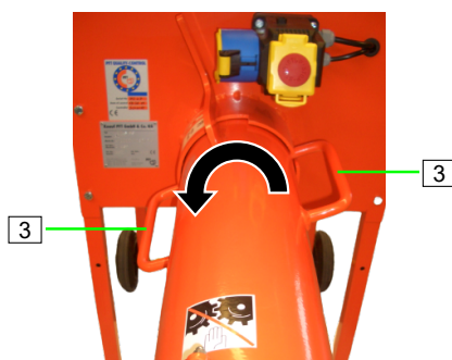
Ábra 39: A keverőcső levétele
