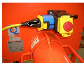
Фигура 35: Прекъсване на подаването на ток
