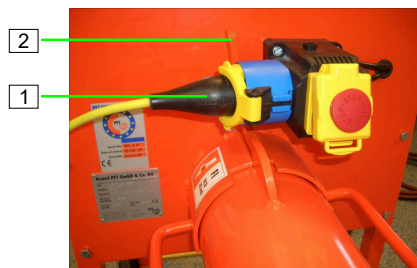
slika 38: Uklanjanje priključnog kabla
