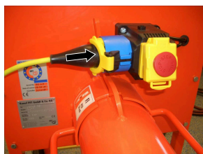
slika 22: Povezivanje električnog priključka
