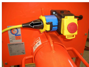
slika 35: Prekidanje električnog napajanja
