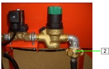
slika 16: Priključak za vodu bez pumpe za povećanje pritiska
