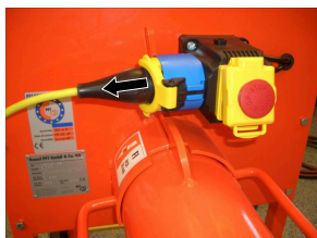
slika 45: Uklanjanje priključnog kabla
