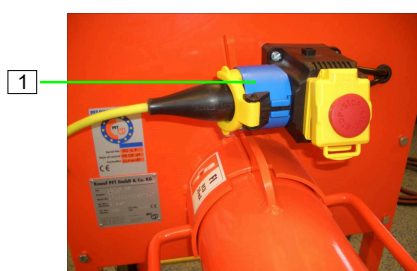
slika 15: Priključak za struju
