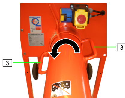
slika 39: Uklanjanje cevi za mešanje
