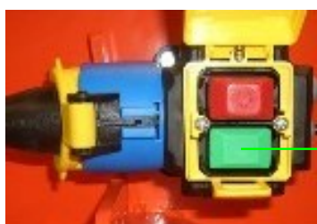
slika 32: Uključivanje mašine
