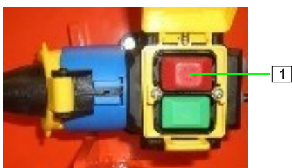
slika 34: Isključivanje mašine
