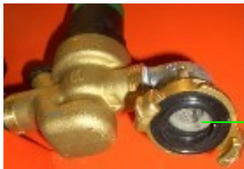
slika 23: Provera sita prečistača
