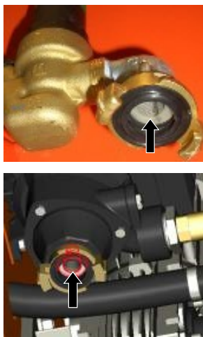
slika 46: Sito prečistača u ulazu vode
