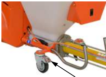
Fig. 19: Rueda con freno
