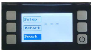
Fig. 62: Indicación sin presión
