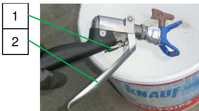
Fig. 43: Palanca de seguro
