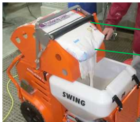
Fig. 31: Vaciar el saco de material
