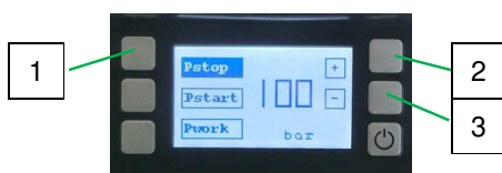
Fig. 36: Presión de desconexión (Pstop)
