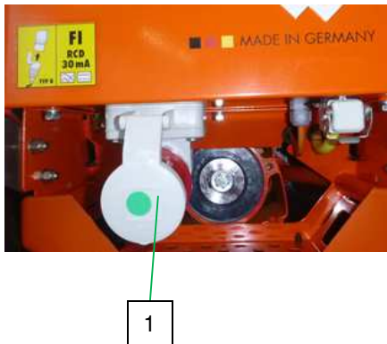
Fig. 11: Conexión eléctrica
