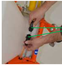
Fig. 70: Desconexión de presión
