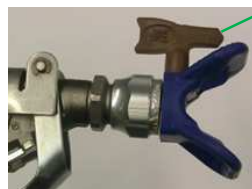
Fig. 27: Insertar la boquilla
