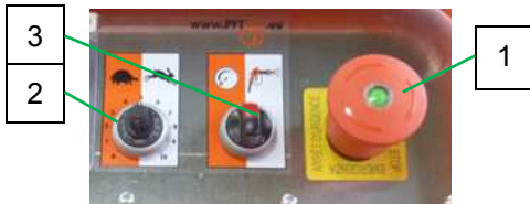
41 pav.: siurblio variklio perjungiklis
