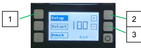
35 pav.: išjungimo slėgis („Pstop“)
