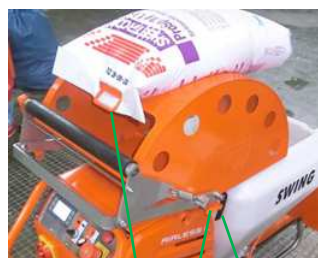
29 pav.: maišų ištuštinimo volas
