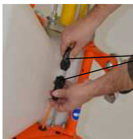
Kuva 69: Paineen katkaisu
