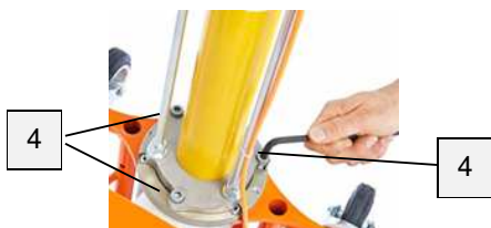
Фиг. 70: Разхлабване на болтовете
