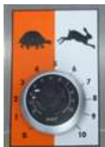
Фиг. 13: Режим на работа регулатор на оборотите
