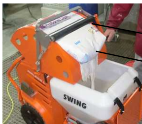
Фиг. 30: Изпразване на чувал с материал
