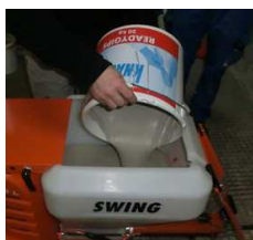
Фиг. 28: Пълнене на резервоара за материали
