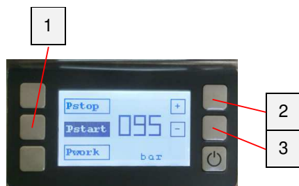
Фиг. 36: Налягане за включване (Pstart)
