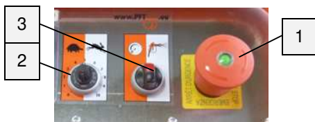
Fig. 41: Comutator selectiv motor pompă
