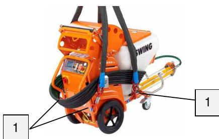
Fig. 15: Puncte de fixare
