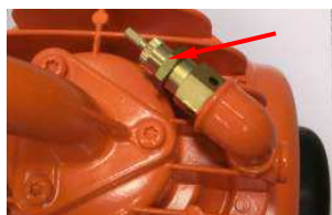
Рис. 73. Предохранительный клапан
