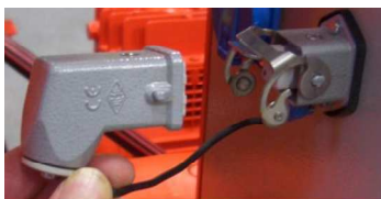
Рис. 40. Вставить разъем-заглушку
