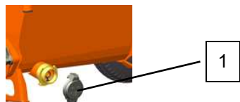
Рис. 28. Открыть патрубки для очистки жидкости
