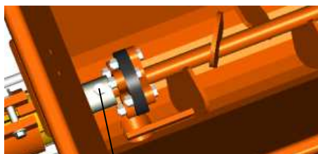
Рис. 68. Ослабление гаек
