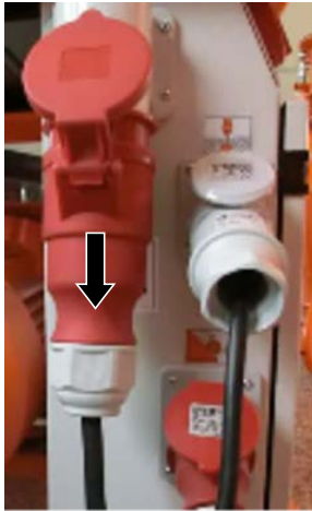
Afbeelding 29: Stroomtoevoer onderbreken
