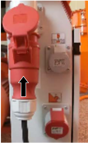
Afbeelding 14: Stroomvoorziening aansluiten
