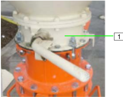
Afbeelding 22: Silo-uitloopklep openen
