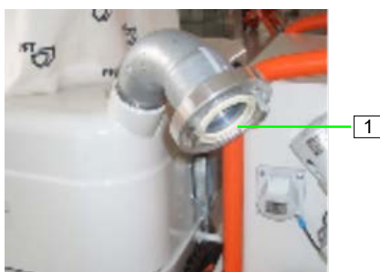
Afbeelding 19: Transportslang aansluiten
