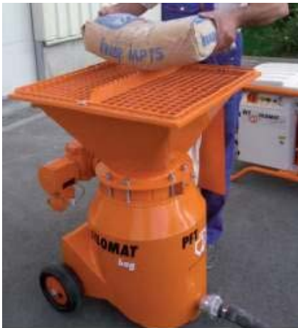
Afbeelding 23: Vullen met product uit zakken
