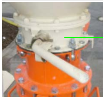
Afbeelding 39: Silo-uitloopklep sluiten
