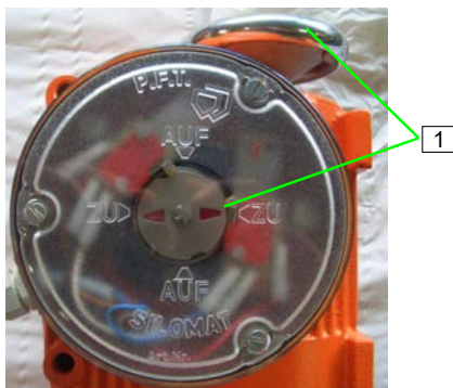
Afbeelding 34: Aandrijfmecanisme
