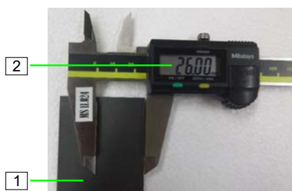
Afbeelding 53: Schuiverbreedte controleren
