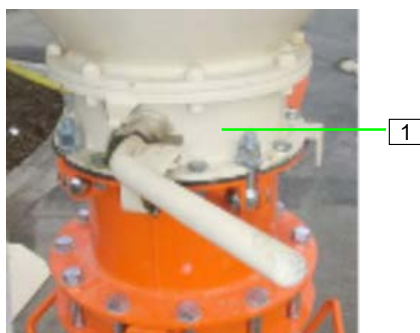
Afbeelding 32: Silo-uitloopklep sluiten
