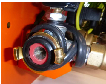
Abb. 55: Schmutzfängersieb im Wassereinlauf
