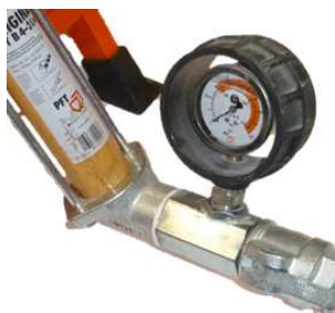
Illustration 51 : Indicateur de pression du mortier
