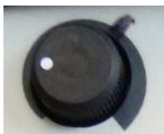
Illustration 17 : Potentiomètre
