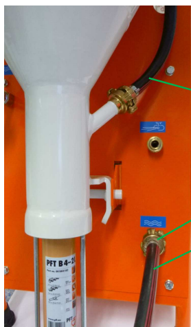
Illustration 37 : raccordement du tuyau à eau
