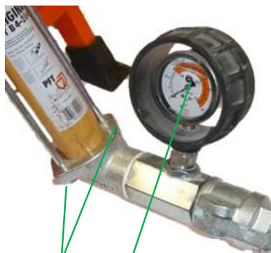
Illustration 72 : Contrôle de la pression du mortier
