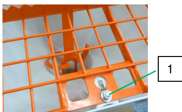
Illustration 27 : serrage de l'écrou
