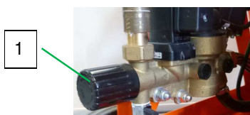
Illustration 100 : Vanne de détente
