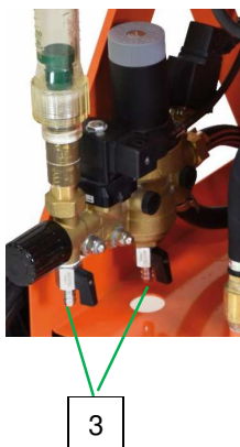
Illustration 95 : Ouverture du robinet de vidange
