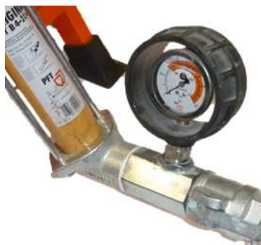
Illustration 26 : Indicateur de pression du mortier
