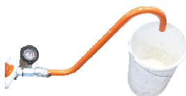
Illustration 54 : Tube de contrôle de consistance
