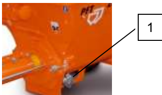
68. attēls: tīrīšanas vāciņa atvēršana
