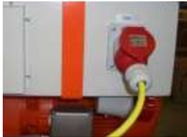
27. attēls: vibratora pieslēgšana
