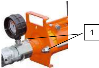
69. attēls: uzgriežņu atskrūvēšana
