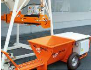
32. attēls: ZP3 piepildīšanas ar materiālu
