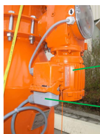
Illustration 18 : Raccorder le câble de commande
