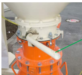
Illustration 29 : fermer le clapet de la sortie du silo
