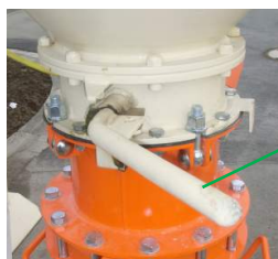
Illustration 19 : Ouvrir le clapet de sortie du silo
