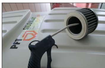
Illustration 47 : Nettoyer les cartouches filtrantes
