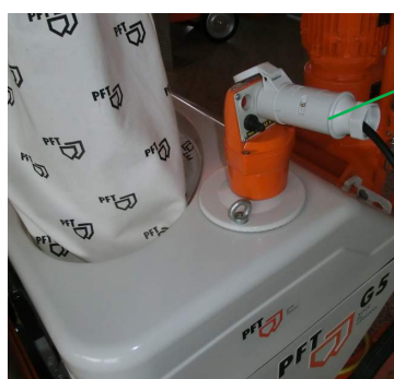
Illustration 33 : Retirer la prise de commande
