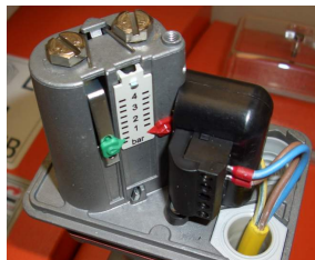
Illustration 50 : Interrupteur de sécurité de la pression de l'air
