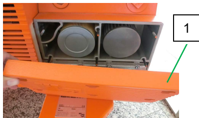
Illustration 45 : Desserrer le couvercle du filtre
