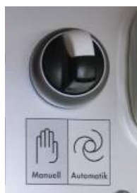
Illustration 8 : modes de fonctionnement du compresseur d'air
