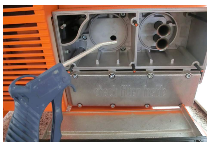
Illustration 48 : Nettoyer le boîtier du filtre
