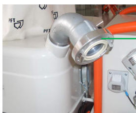
Illustration 14 : Raccorder le tuyau de refoulement
