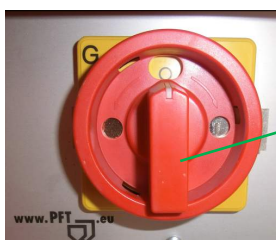
Illustration 30 : Mise hors tension
