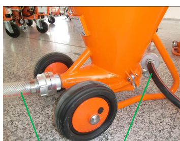
Illustration 14 : Raccorder le tuyau de refoulement
