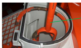
Fig. 96: Retirar o eixo de mistura
