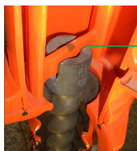
Fig. 93: Encaixe do rotor
