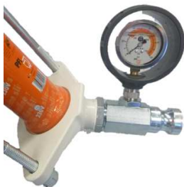
Fig. 33: Manômetro de pressão da argamassa
