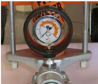
Fig. 50: Manômetro de pressão da argamassa
