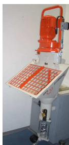
Fig. 35: Unidade misturadora da bomba
