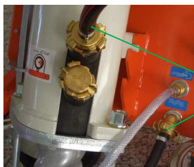
Fig. 95: Desligar a entrada de água
