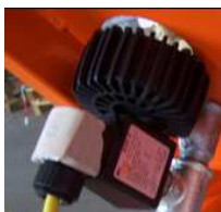
Fig. 104: Pressostato da água
