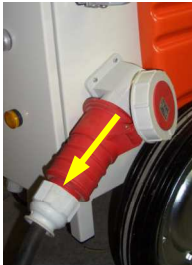
Fig. 100: Retirar o cabo de ligação
