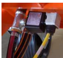
Fig. 105: Pressostato do ar
