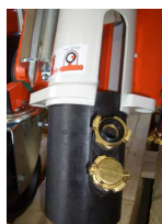
Fig. 92: Limpar o tubo de mistura de borracha
