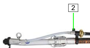
ilustracja 45: Otwieranie kurka sprężonego powietrza
