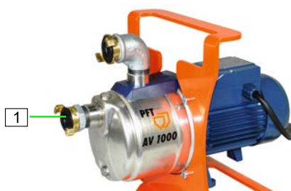
Abb. 60: Pumpe füllen
