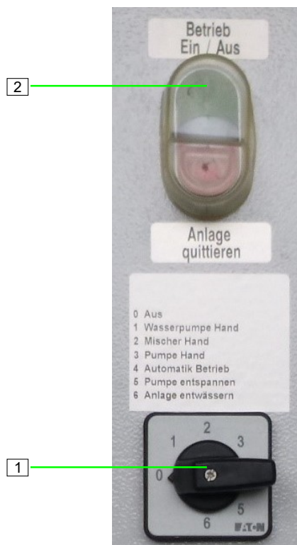
Abb. 51: Pumpe auf Handbetrieb stellen
