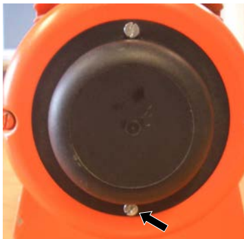
Abb. 97: Filterabdeckung abnehmen
