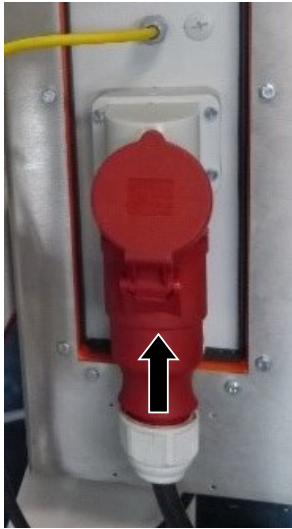
Abb. 33: Stromversorgung anschließen
