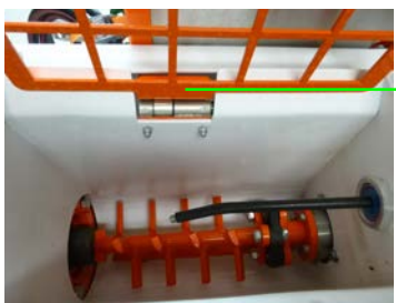
Abb. 30: Scharniersicherheitsschalter
