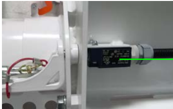
Abb. 29: Positionsschalter
