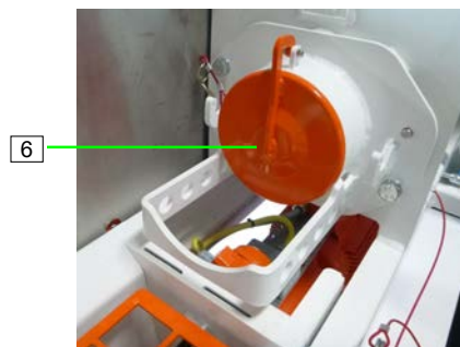
Abb. 85: Mischrohrabdeckung schließen
