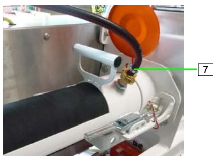
Abb. 42: Wasserschlauch anschließen
