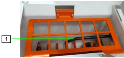
Abb. 88: Füllstandsonde reinigen
