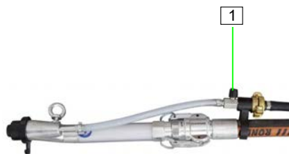
Abb. 66: Lufthahn öffnen
