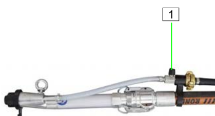
Abb. 67: Lufthahn schließen
