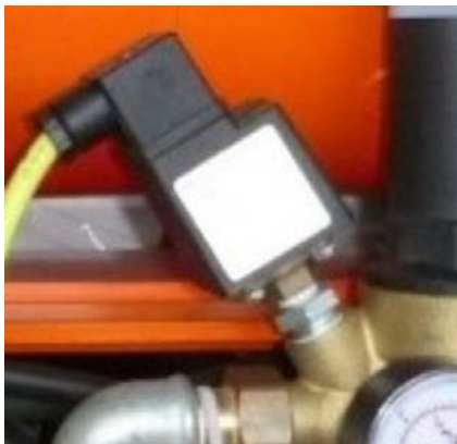
Abb. 102: Druckschalter Wasser
