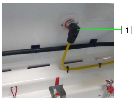
Abb. 47: Füllstandsonde
