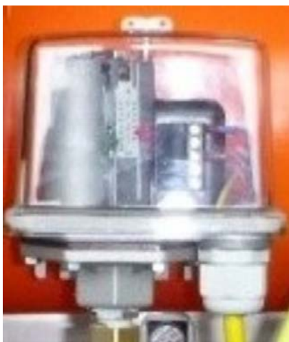
Abb. 103: Druckschalter Luft
