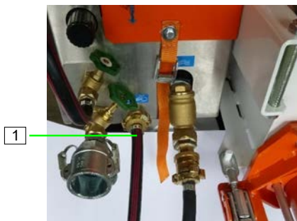
Abb. 54: Luftschlauch anschließen
