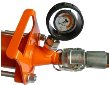
Abb. 31: Mörteldruckmanometer
