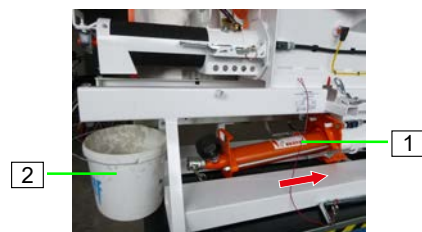
Abb. 44: Pumpenbehälter verschieben
