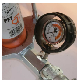
图 16：砂浆压力计
