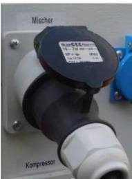
图 25：混合器电机接口
