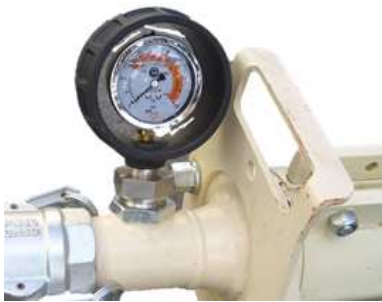
图 46: 砂浆压力计
