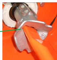
Fig. 86: Assentamento da pinça de arrastamento
