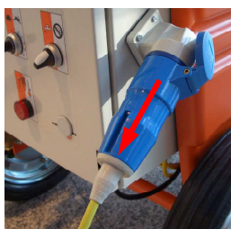
Fig. 92: Retirar o cabo de ligação
