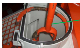
Fig. 88: Retirar o eixo de mistura
