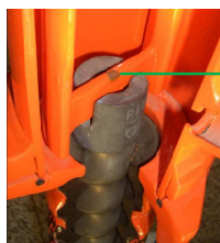
Fig. 85: Assentamento do rotor
