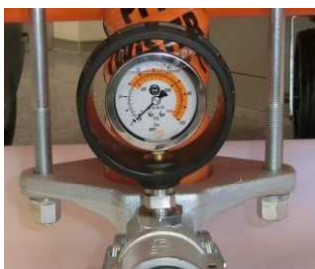
Fig. 42: Manômetro de pressão da argamassa
