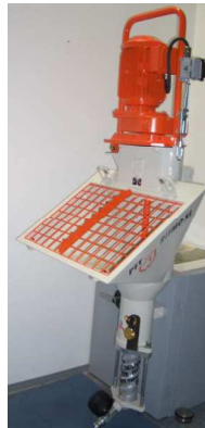
Fig. 27: Unidade misturadora da bomba
