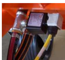
Fig. 99: Pressostato do ar
