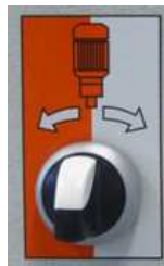
Fig. 16: Modos de funcionamento do motor da bomba
