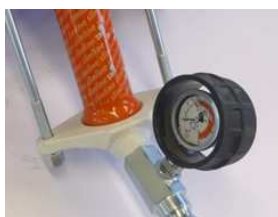
Fig. 25: Manómetro de pressão da argamassa
