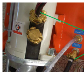
Fig. 87: Desligar a entrada de água
