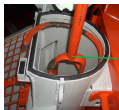
Fig. 78: Retirar o eixo de mistura
