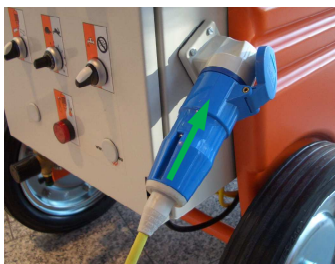
Fig. 31: Ligar à corrente 230V 50Hz
