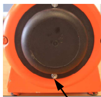
Fig. 95: Abertura cobertura do filtro
