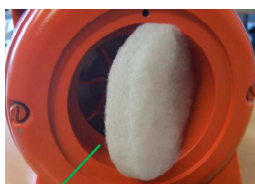
Fig. 94: Filtro do compressor de ar
