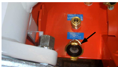
Fig. 102: Limpieza del tamiz
