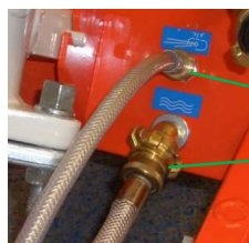
Fig. 98: Conectar la manguera de aire
