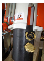
Fig. 92: Limpieza de zona de mezcla de goma
