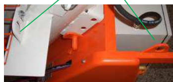
Fig. 28: Transporte con grúa
