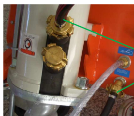
Fig. 87: Desconectar la toma de agua
