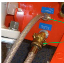
Fig. 90: Conectar la manguera de aire
