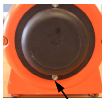
Fig. 95: Abertura de la cubierta del filtro
