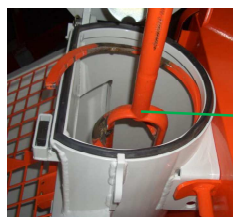
Fig. 78: Extraer la hélice mezcladora
