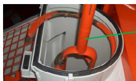
Fig. 88: Extraer la hélice mezcladora
