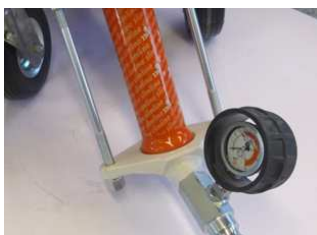
Fig. 25: Manómetro de presión del mortero
