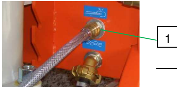
Fig. 52: Conectar la manguera de aire
