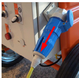
Fig. 92: Retirar el cable de conexión
