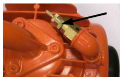
Fig. 101: Válvula de seguridad
