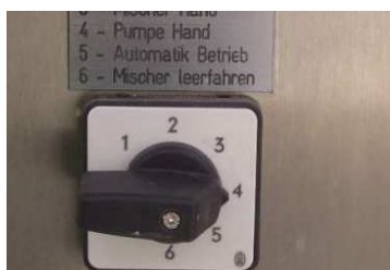
Afb. 71: Pompreservoir leegmaken.
