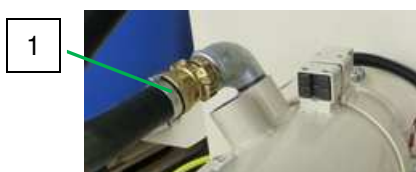
Afb. 30: Waterslang afkoppelen
