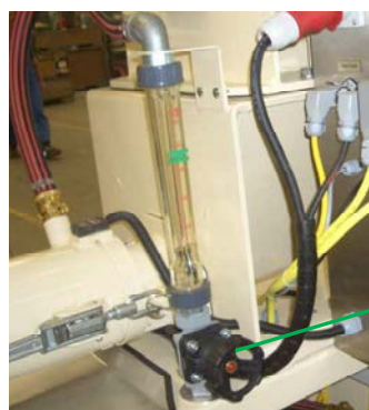
Afb. 34: Membraanklep
