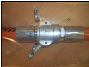
Afb. 57: Koppeling losmaken
