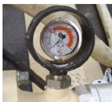
Afb. 40: Morteldrukmanometer
