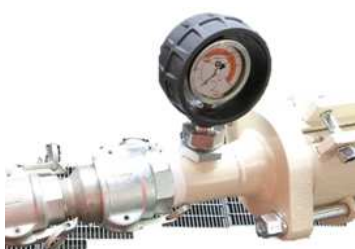
Afb. 38: Morteldrukmanometer
