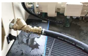
Afb. 73: Waterslang afkoppelen
