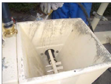
Afb. 68: Pompreservoir reinigen
