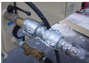
Afb. 62: Materiaalslangen loskoppelen
