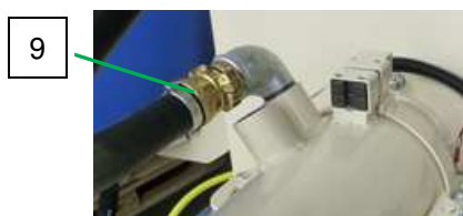
Afb. 35: Waterslang aansluiten
