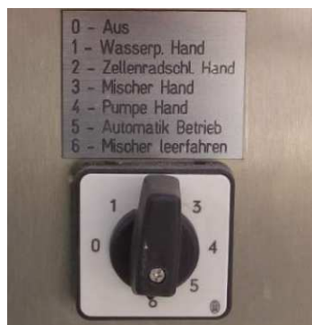
17. att. Izvēles slēdzis maisītāja iztukšošanas režīmā
