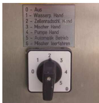
13. att. Izvēles slēdzis lāpstīņveida padevēja pozīcijā
