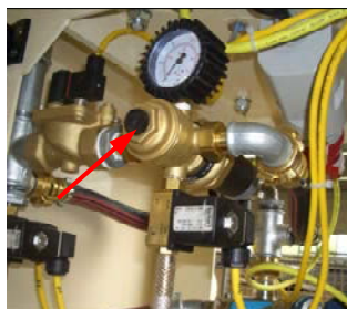
84. att. Redukcijas vārsta netīrumu uztveršanas siets
