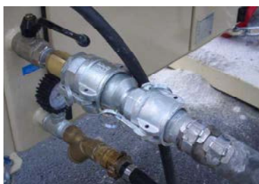
62. att. Materiāla šļūteņu atvienošana
