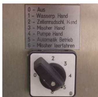
16. att. Izvēles slēdzis automātiskajā režīmā
