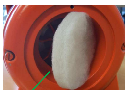
Рис. 94: Фильтр воздушного компрессора
