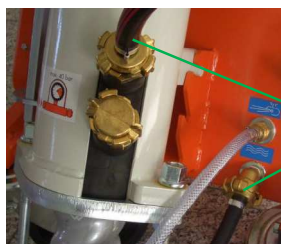
Рис. 87: Отсоединение подачи воды
