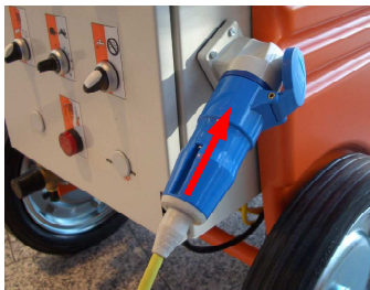
Рис. 31: Подключение тока 230 В 50 Гц
