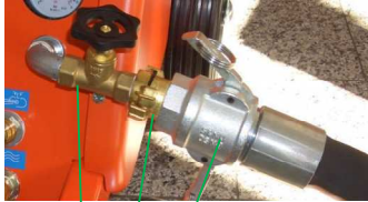
Рис. 49: Подготовка рукава подачи раствора
