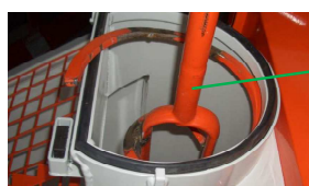
Рис. 88: Снятие смесительной спирали
