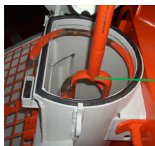
Рис. 78: Снять смесительную спираль
