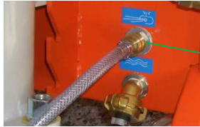
Рис. 52: Присоединение воздушного шланга
