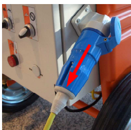
Рис. 92: Демонтаж соединительного кабеля
