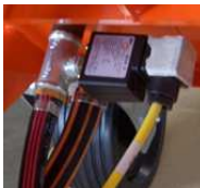
Рис. 99: Реле давления воздуха
