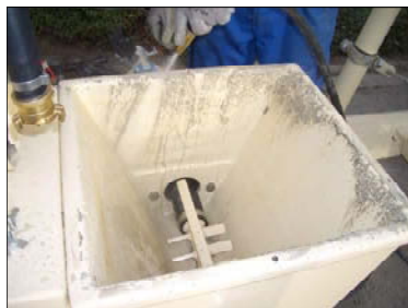
Fig. 68: Pulizia della tramoggia della pompa
