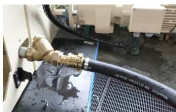
Fig. 73: Staccare il tubo flessibile dell'acqua
