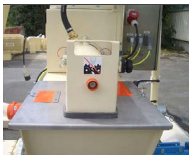
Fig. 70: Montaggio del tubo di miscelazione
