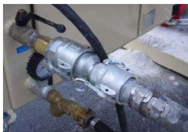
Fig. 62: Staccare i tubi flessibili del materiale
