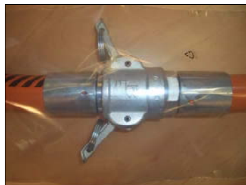
Fig. 57: Distacco del giunto
