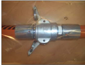
Fig. 57: Loosen coupling
