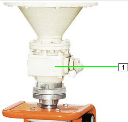
slika 41: Zatvaranje ispusnog poklopca silosa
