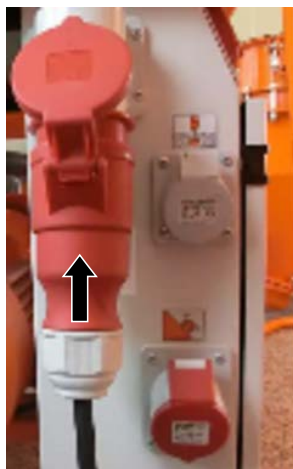
slika 14: Povezivanje električnog priključka
