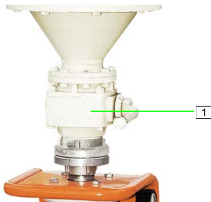
slika 36: Zatvaranje ispusnog poklopca silosa
