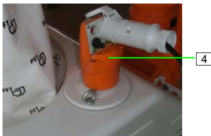
slika 17: Povezivanje upravljačkog kabla
