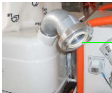
slika 19: Prikliučivanje creva za materijal
