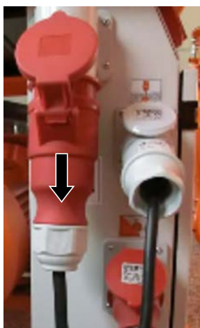
slika 33: Prekidanje električnog napajanja
