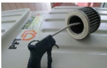
slika 63: Čišćenje uloška filtera
