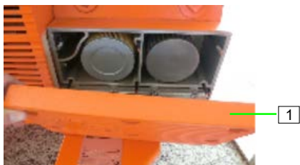
slika 61: Otpuštanje poklopca filtera
