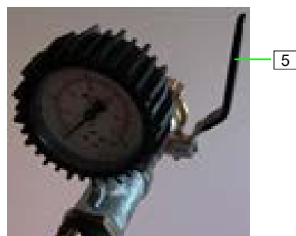
slika 22: Zatvoriti zaporni ventil
