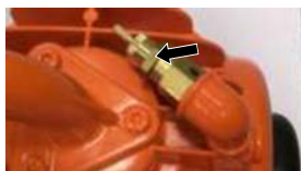
Obrázek 96: Pojistný ventil
