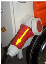
Sl. 100: Uklanjanje priključnog kabela
