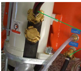
Sl. 95: Odvajanje dovoda vode
