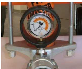
Sl. 50: Manometar tlaka morta
