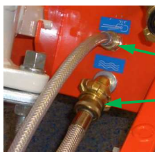
Sl. 98: Priključiti crijevo zraka
