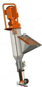
Sl.8: Sklop spremnika materijala
