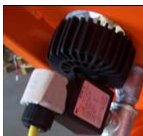
Sl. 104: Tlačna sklopka za vodu
