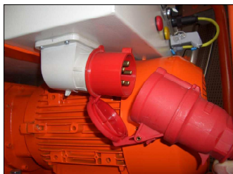
Obr. 52: Odstranění připojovacího kabelu
