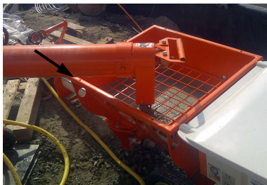
Obr. 26: Plnění materiálu do zásobníku
