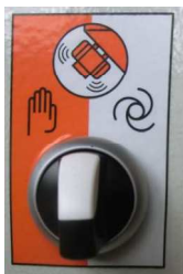
Obr. 11: Provozní režimy vibračního zařízení
