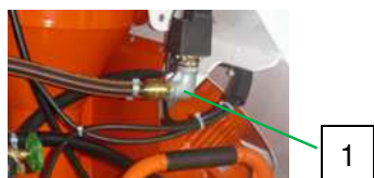
图 55: 连接空气软管
