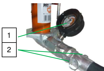
图 75: 砂浆压力为“0”bar
