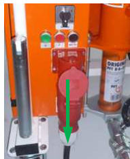
图 93: 取下连接电缆
