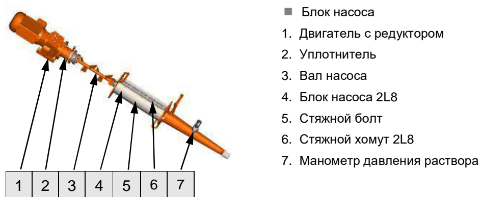
Рис. 8: Узел блок насоса
