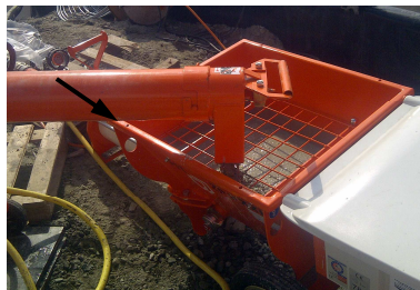
Рис. 26: Заполнить бункер материалом
