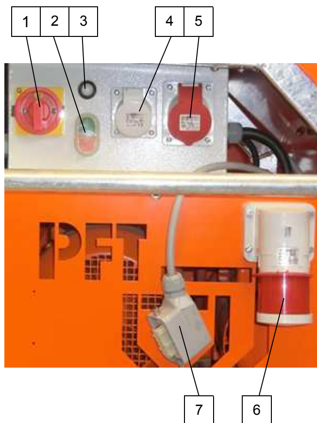
Рис. 5: Обзор электрощкафа и подключения
