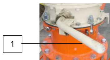
Рис. 31: Снять контейнер для транспортировки
