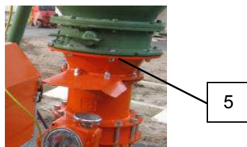
Рис. 33: Снять контейнер для транспортировки
