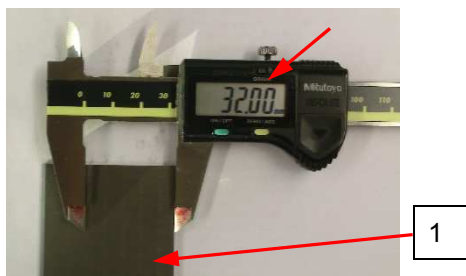
Рис. 46: Проверить ширину шибера
