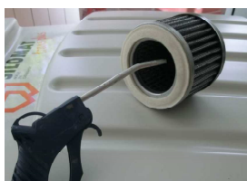
Рис. 44: Очистить фильтрующие элементы
