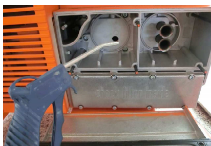
Рис. 45: Очистить корпус фильтра
