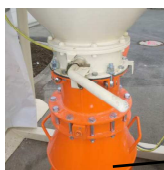
Рис. 9: Подключить контейнер для транспортировки
