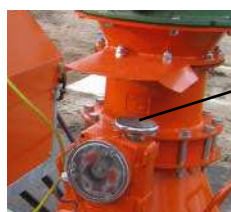
Рис. 21: Открыть запорный клапан
