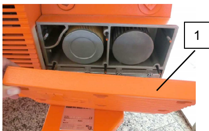
Рис. 42: Снять крышку фильтра
