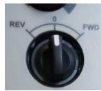
图 71：将选择开关旋至“0”位
