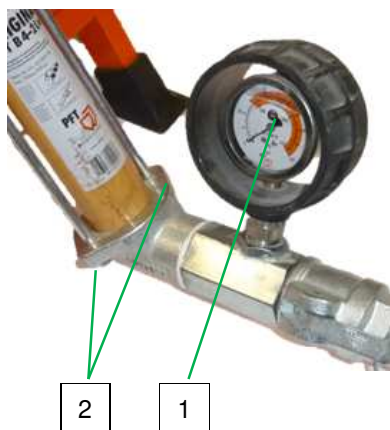
图 72: 检查砂浆压力
