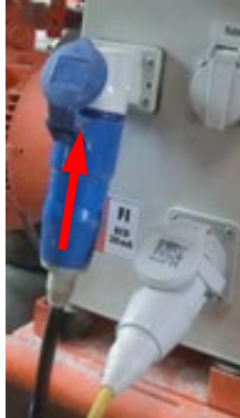
Abb. 13: Stromversorgung anschließen
