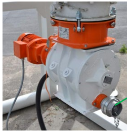
Abb. 16: Förderschlauch anschließen
