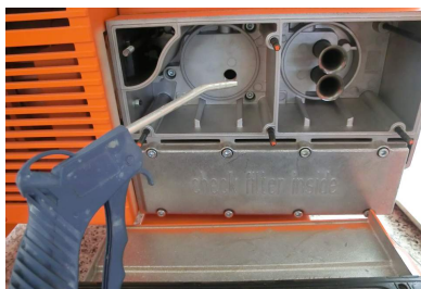
Abb. 44: Filtergehäuse reinigen
