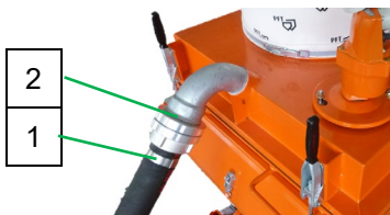
Abb. 15: Förderschlauch anschließen
