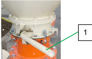
Abb. 31: Siloauslaufklappe schließen
