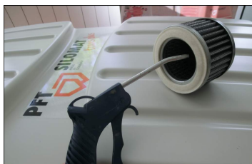
Abb. 43: Filterpatronen reinigen
