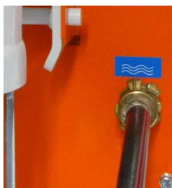
Abb. 1: Wasseranschluss
