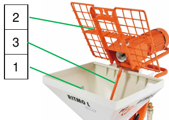
Abb. 86: Schutzgitter öffnen
