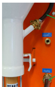
Abb. 94: Wasserzufuhr trennen
