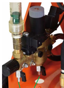
Abb. 94: Wasserzufuhr trennen
