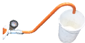
Abb. 54: Konsistenzprüfrohr
