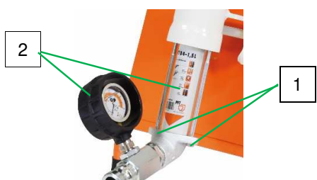
Abb. 93: Pumpeneinheit abnehmen
