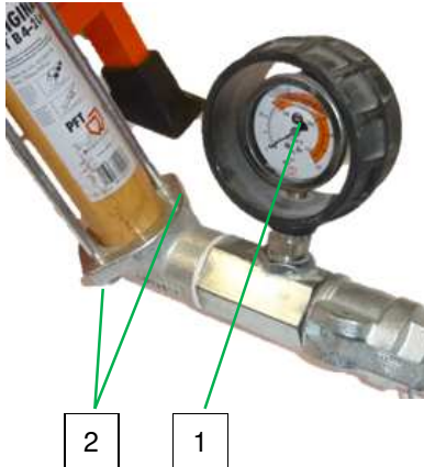
Abb. 72: Mörteldruck überprüfen
