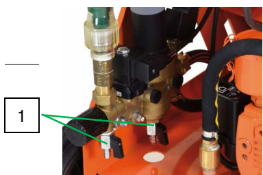
Abb. 41: Wasserablasshähne
