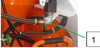
Abb. 55: Luftschauch anschließen
