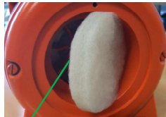
Abb. 95: Filter des Luftkompressors
