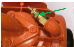
Abb. 99: Sicherheitsventil
