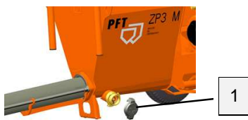
Рис. 34: Открыть патрубки для очистки жидкости
