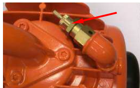
Рис. 81: Предохранительный клапан
