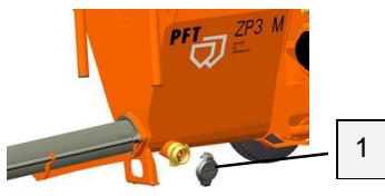
Рис. 73: Открыть патрубки для очистки жидкости
