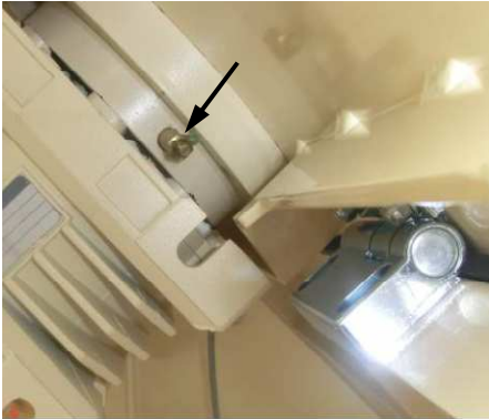
Abb. 96: Getriebemotor abschmieren
