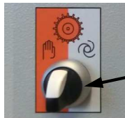
Abb. 68: Mischrohr leer fahren
