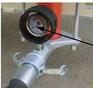
Abb. 70: Mörteldruck auf „0 bar“
