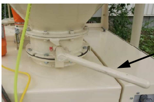
Abb. 40: Siloklappe öffnen
