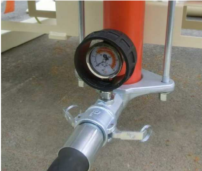
Abb. 38: Mörteldruckmanometer
