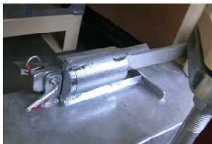
Abb. 75: Mischrohr-reiniger
