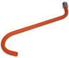
Abb. 43: Konsistenzprüfrohr
