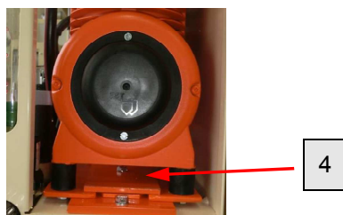
Abb. 92: Luftkompressor heraus ziehen
