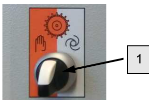
Abb. 73: Mischrohr leer fahren
