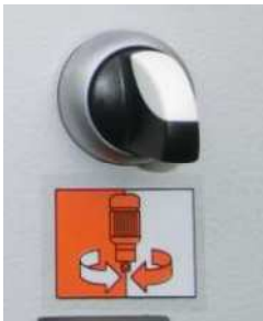
Abb. 14: Betriebsarten Pumpenmotor
