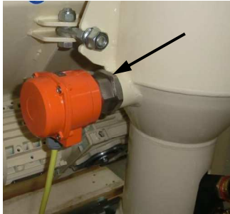
Abb. 23: Füllstandsonde im Mischrohr
