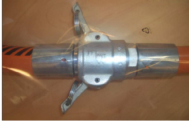
Abb. 63: Kupplung lösen
