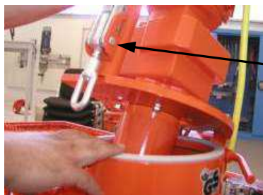
Abb. 76: Motorkippflansch schließen
