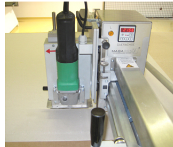
Bild 11.07 Nutsägeaggregat - längs
