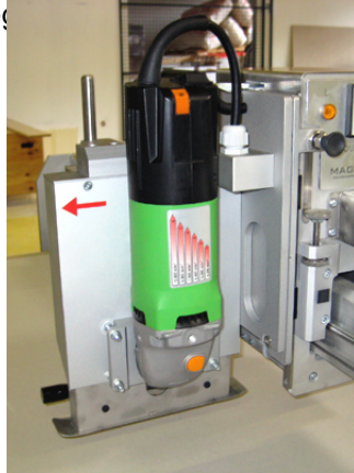
Bild 15.02 Sägeaggregat - längs
