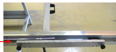
Der vordere Lagerbock mit den beiden Klemmschrauben.
