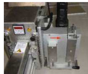
Obrázek 11.07 Agregát drážkovací pily - podélně
