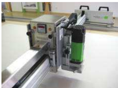
Obrázek 11.01 Frézovací agregát vpravo
