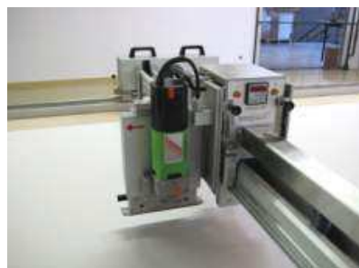
Obrázek 11.04 Pilový agregát podélně - vlevo
