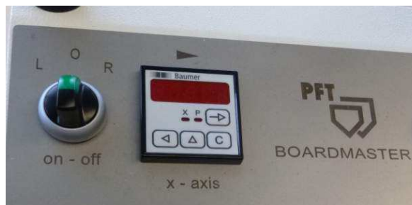
Indikátor podélné osy (X)
