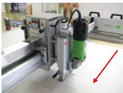
Obrázek 11.05 Pilový agregát příčně - vpravo
