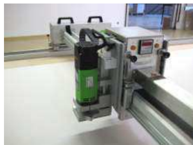
Obrázek 11.02 Frézovací agregát vlevo
