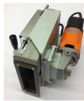
Obrázek 15.03N Agregát drážkovací frézy
