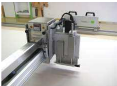
Obrázek 11.03 Pilový agregát podélně - vpravo
