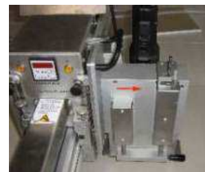
Ил. 11.07 Пильный агрегат для выборки пазов — работа в продольном направлении
