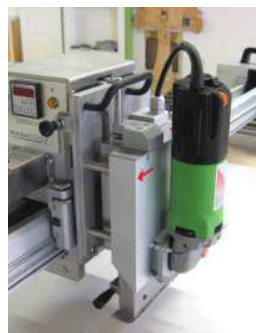
Ил. 15.03 Пильный агрегат — резка в поперечном направлении
