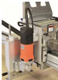
Ил. 15.02 Пильный агрегат — резка в продольном направлении
