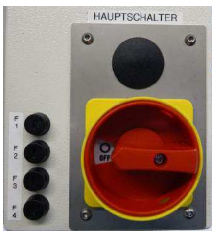
Главный выключатель 0 / 1 с расцепителем минимального напряжения.
