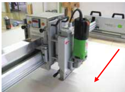
Ил. 11.05 Пильный агрегат в поперечном направлении — справа
