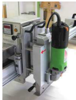
Imagem 15.03 unidade de serra - transversalmente
