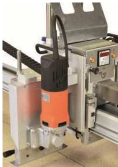
Imagem 15.02 unidade de serra - longitudinalmente
