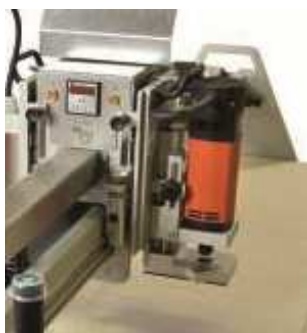
Imagem 11.01 unidade fresadora direita
