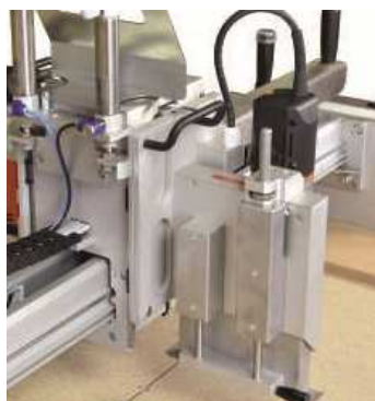
Imagem 11.03 Unidade de serra longitudinalmente - direita
