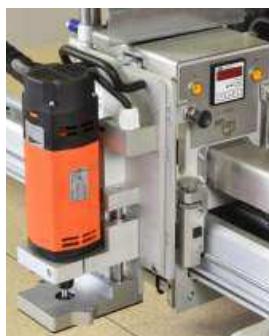
Slika 15.01 Agregat za glodanje
