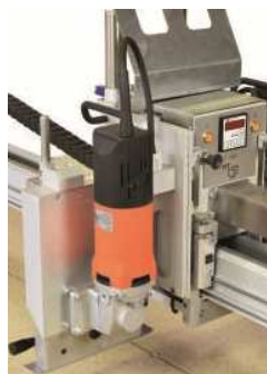
Slika 15.02 Rezni agregat - uzdužno
