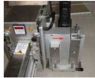
Slika 11.07 Rezni agregat za žljebove - uzdužno
