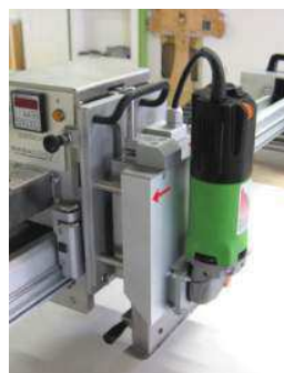
Figura 15.03 Unità di taglio trasversale
