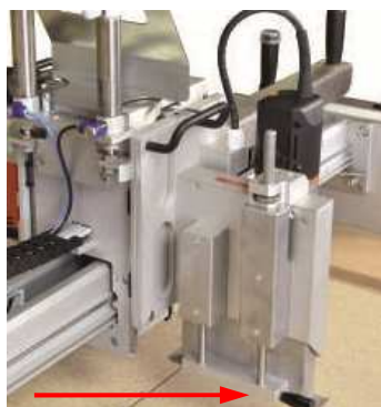
III. 11.03 Groupe de scie longitudinal - à droite
