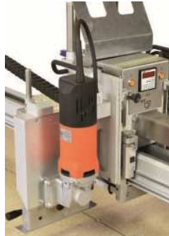
Fig. 15.02 Sawing unit – longitudinal
