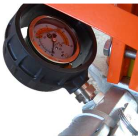
Illustration 27 : Indicateur de pression du mortier
