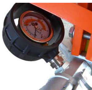
Illustration 53 : Pression du mortier sur « 0 » bar.
