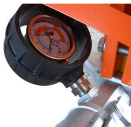
Illustration 51 : Indicateur de pression du mortier
