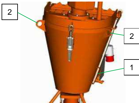
Illustration 20 : Transport par grue
