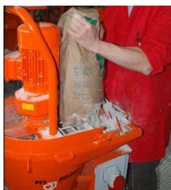
Illustration 33 : Verser le matériau en sac
