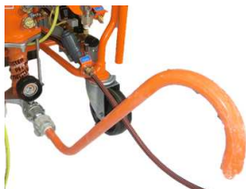
图 50: 稠度检测管
