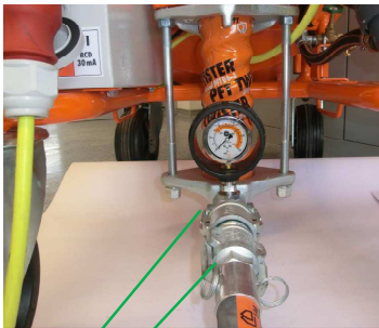
图 55: 连接砂浆软管
