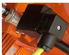
图 104: 空气的压力开关
