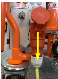
图 97：取下连接电缆
