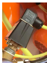
图 103: 水的压力开关
