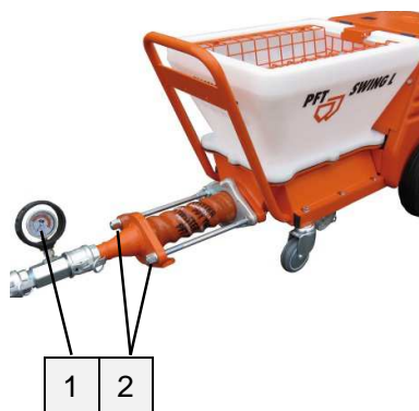
Рис. 61: Проверка давление раствора
