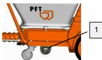
Рис. 77: Открытие патрубков для очистки
