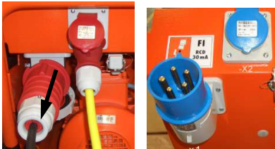
Рис. 81: Демонтаж соединительного кабеля
