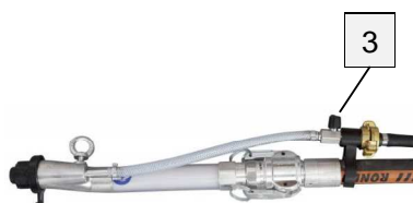
Рис. 51: Открытие воздушного крана
