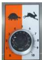
Рис. 12: Режимы регулятора частоты вращения
