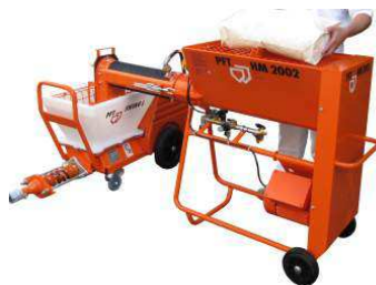
Рис. 37: Наполнение SWING L материалом
